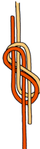
b) spojení dvou lan pomocí protisměrného osmičkového uzlu
